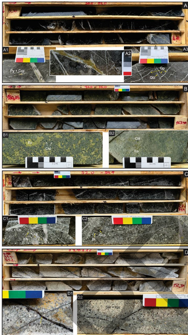
Fig. 4. Muestras de testigos de roca del Bajo de La Alumbrera. A. Pozo 50.0-59.0. Roca andesítica con alteración potásica; A1: venilla de yeso (Gp) con pirita (Py) y asociación de pirita y calcopirita (Ccp); A2: detalle de calcopirita y venillas de yeso y cuarzo (Qtz); A3: detalle de venilla mayoritariamente de yeso junto a otras de cuarzo. B. Pozo 46.0-33.0. Roca andesítica con alteración de tipo clorita-epidota; B1: epidota (Ep) en parches en la matriz de la roca, junto a clorita (Chl) secundaria tanto en la matriz como en minerales máficos; B2: epidota y clorita como minerales de reemplazo en la matriz. C. Pozo 52.0-54.4. Pórfido dacítico con alteración potásica típica; C1: cristales de feldespato potásico (Kfs) y biotita secundarios, con calcopirita (Ccp), pirita (Py) y magnetita, venillas de cuarzo (Qtz) y carbonatos (Cb); C2: alteración potásica con presencia de feldespato potásico y biotita (Bt), magnetita en matriz y venillas capilares, y calcopirita en matriz y venillas. D. Pozo 39.4-63.2. Pórfido dacítico con alteración destructiva de feldespatos; D1: sericita en cristales de plagioclasa, cuarzo en la matriz, venillas de pirita (Py) y óxidos secundarios, y presencia de limonita (Lm); D2: fenocristales de plagioclasa con reemplazo de sericita (Ser) y caolinita (Kln), clorita sobre biotita, y venilla con óxidos. Ubicación de pozos en figura 2.
