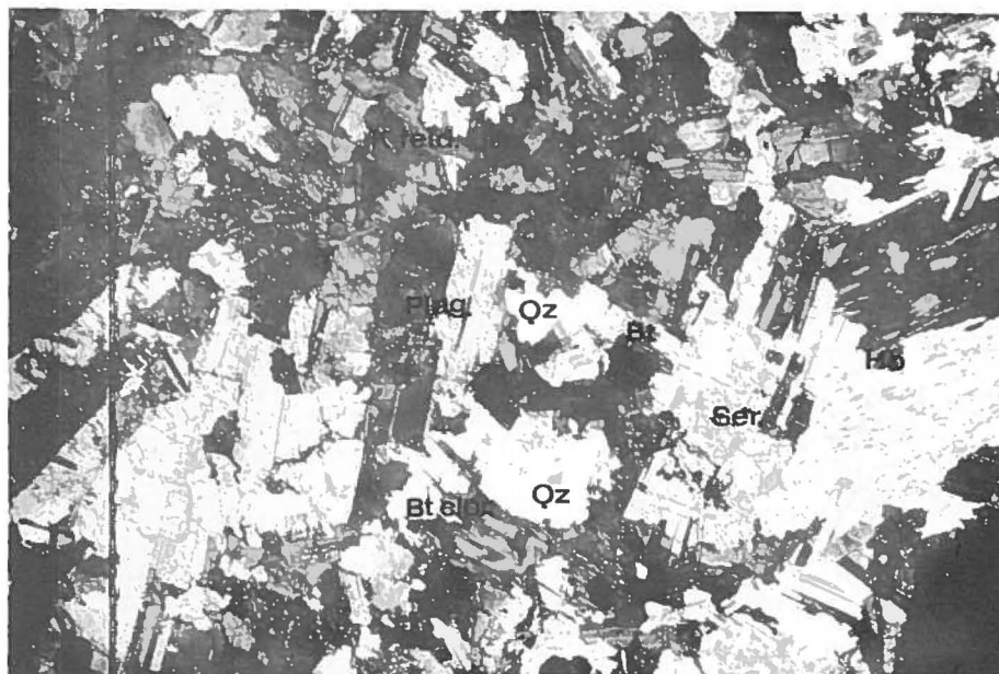
Foto 2. Diorita Sewell (muestra DDH-1091A - 2842'). Textura hipidiomórfica granular, constituida por cristales de 0,5-1 mm de longitud, de plagioclasa y hornblenda, con alteración potásica moderada, que se expresa como biotización de las anfíbolas y pertitización de las plagioclasas. La roca se observa, en general, de aspecto "sucio" por la alteración sericitica débil, que la afecta en forma maciza. En la parte fina de la roca se desarrolla un mosaico de cuarzo y feldespato potásico y aparecen opacos diseminados (calcopirita y pirita). (Nícoles cruzados; campo 2,3 x 3,5 cm.) Edad obtenida en roca total: 7,1 \pm 1,0 Ma.
