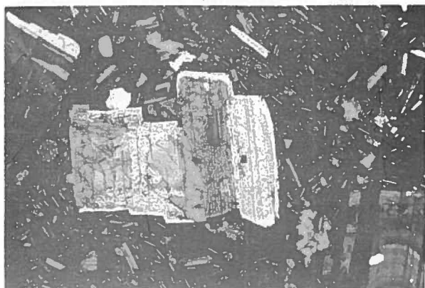
Foto 3. Microfotografía de un glomerocrystal de plagioclase, que muestra acoplamiento sinéutico de cuatro individuos según las caras (010) y texturas cribadas de reabsorción, al interior de cada cristal, dejando como relicto, sin reaccionar, la zona del núcleo. El anillo periférico común indica el reinicio de la cristalización (Nícoles X, aumento 4 x 10).
