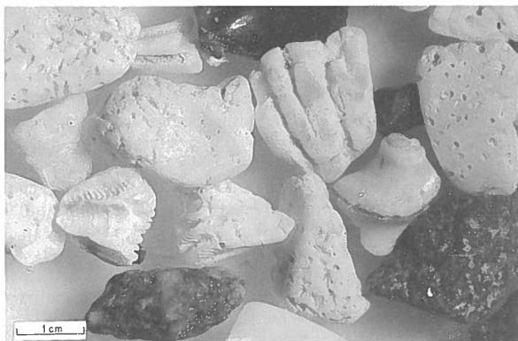
FIG. 9. Muestra 2: bioclastos (gastropodos, pelecípodos) y fragmentos líticos.
